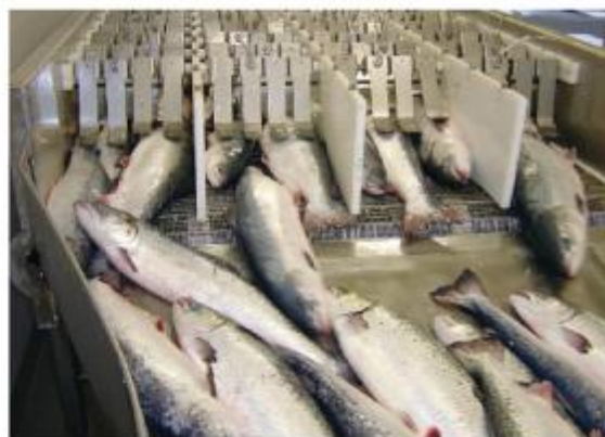
I bedøveren fra Kjølås Stansekniver går strømmen fra stålammeller, gjennom fisken og ned i transportbeltet.
