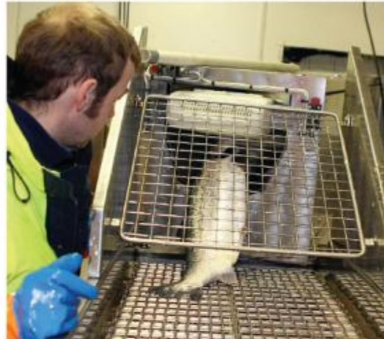
Bedøveren til Sotra Maskin Produkter består av en todelt renne hvor strømmen passerer gjennom fisken fra den ene til den andre siden av rennen.
