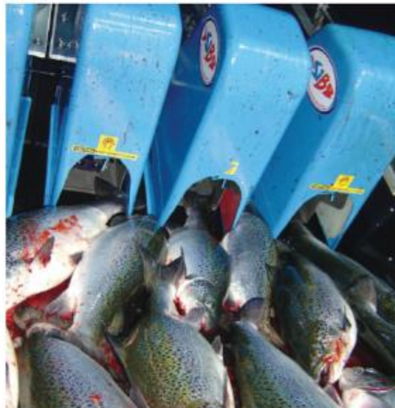
I det australske slaktesystemet fra Seafood Innovations svømmer fisken selv inn i slagmaskinen og blir deretter automatisk bløgget.
